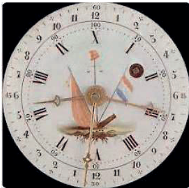
Cadran d'horloge décimale avec double graduation comme le cadran de l'horloge commandée par le conseil municipal de Pleaux
